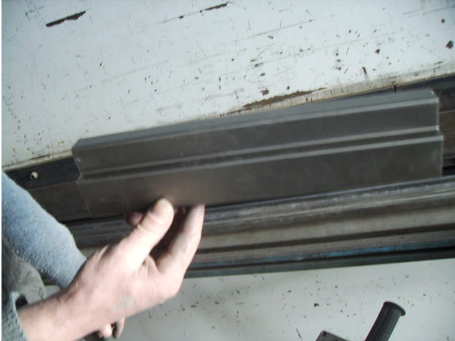
Resim 1.4: Sacların uygun ölçülerde kıvrılması
