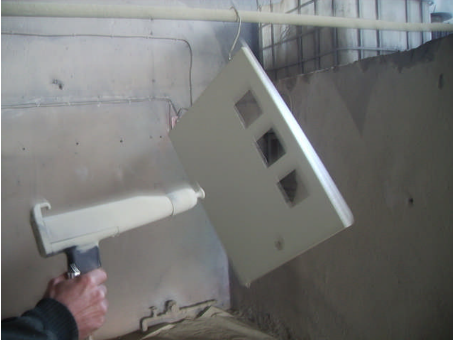
Resim 1.6: Parçaların uygun şekilde tabanca ile boyanması
