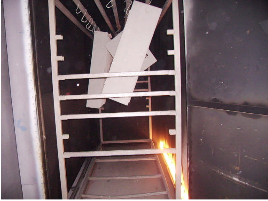
Resim 1.7: Parçaların uygun sıcaklıkta fırınlanması
