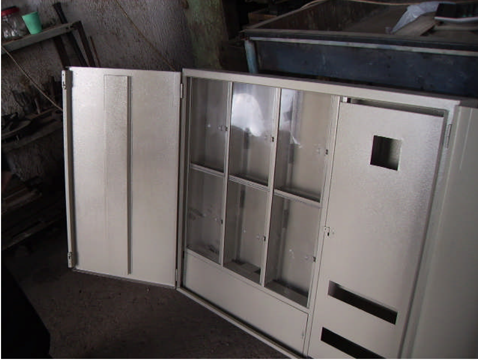
Resim 1.9: Parçaları tamamlanmış dâhilî tip bir pano
